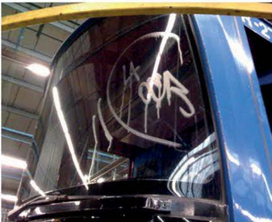
Verätzungen in Busscheibe (Glas) durch Säure
