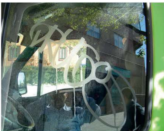
Verätzungen im Glas durch Säure
